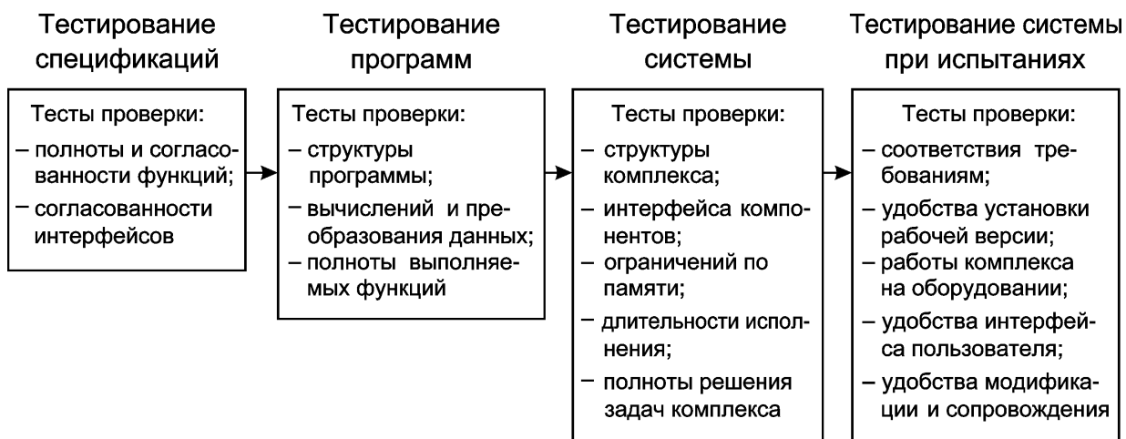
РИС. 7.3. Классификация тестов проверки объектов тестирования
