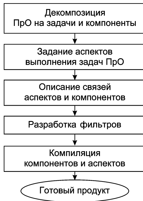
РИС. 2.9. Технологическая схема проектирования ПС в АОП
