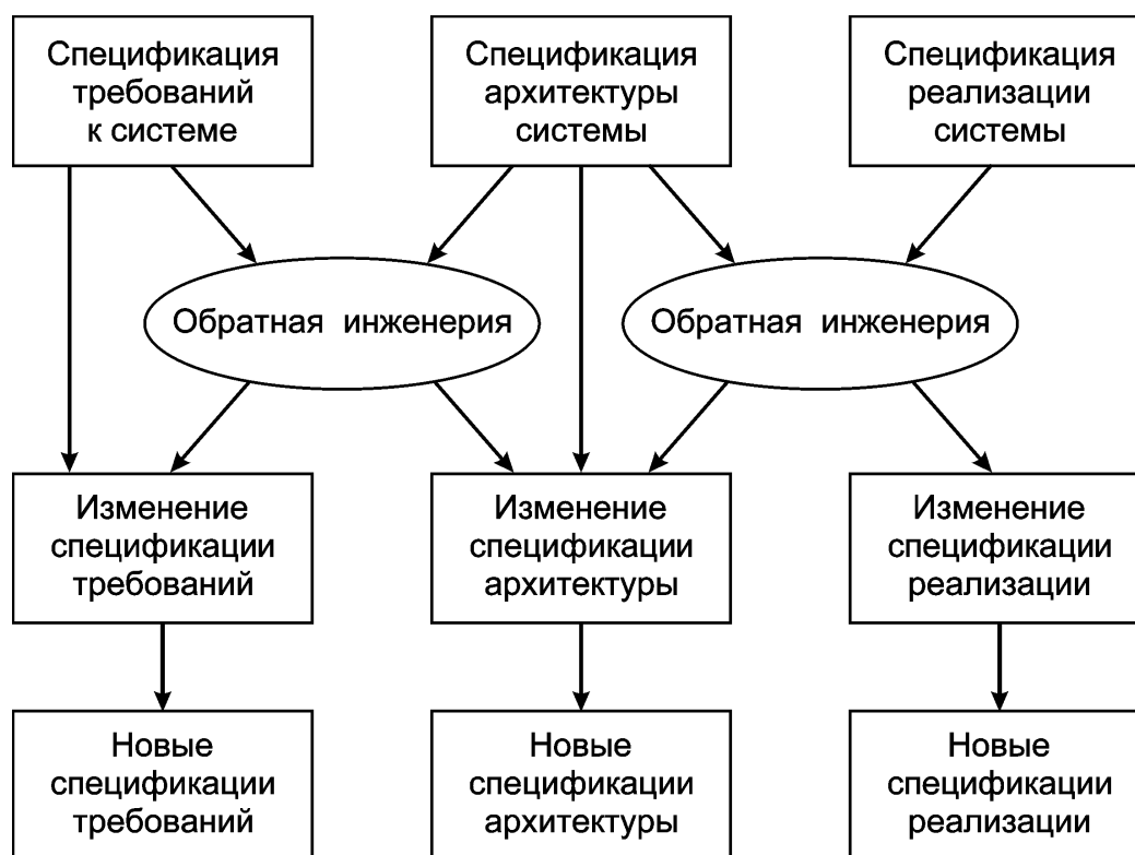
РИС. 5.3. Процесс обратной инженерии описания системы
