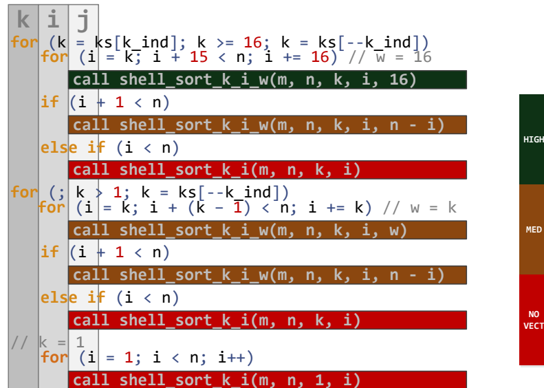
Рис. 5.30. Декомпозиция сортировки Шелла для выделения векторизуемых участков кода
