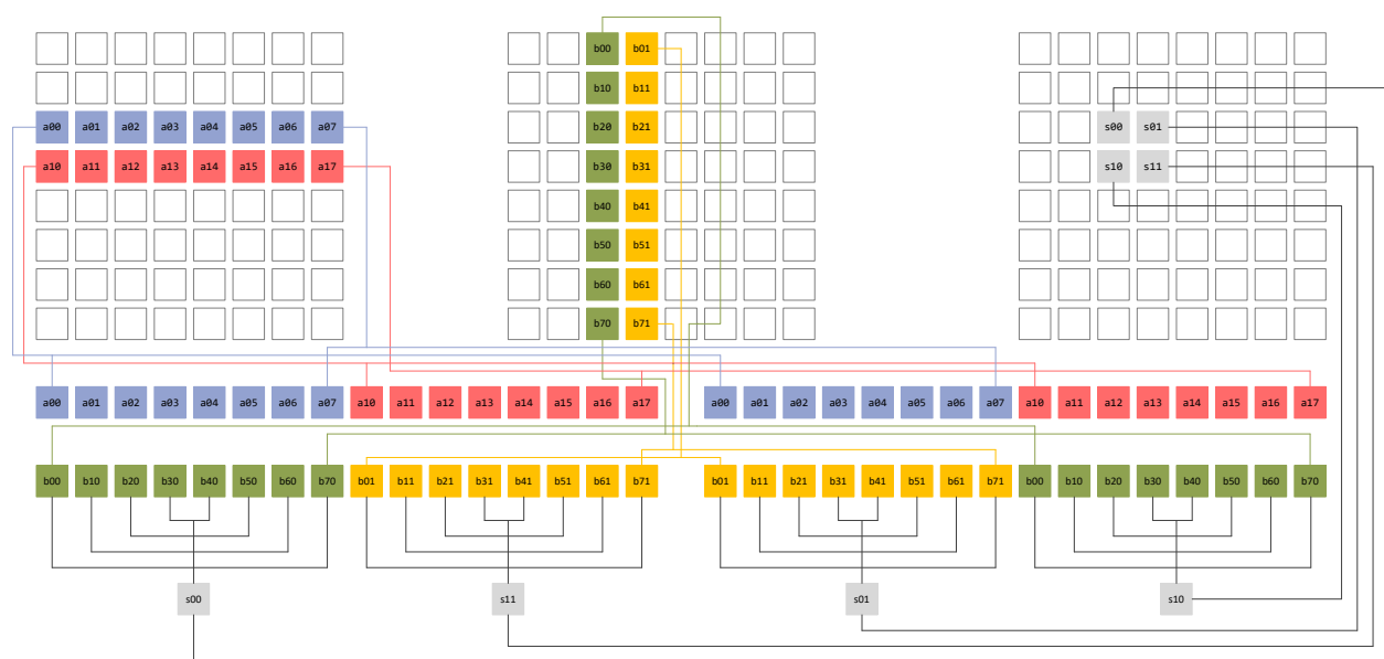
Рис. 5.1. Схема вычисления результата в операции matmat8
