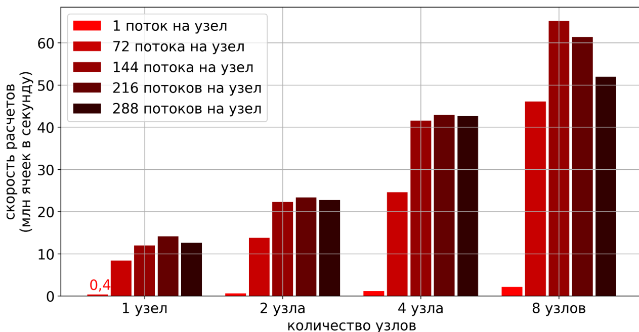
Рис. 4.14. Производительность вычислений по моделированию обледенения на вычислительных узлах МВС-10П МП2
