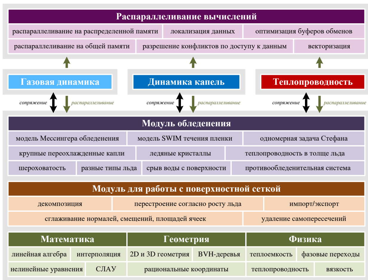
Рис. 1.9. Схема программного комплекса компьютерного моделирования процесса обледенения элементов авиационных силовых установок «Кристалл»
