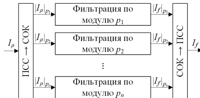
Рисунок 2.1.2. Фильтрация изображения в СОК
