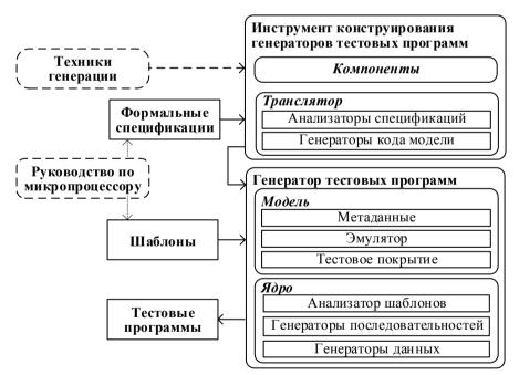
Рисунок 4. Инструмент, реализующий предлагаемый метод, и результат его работы
